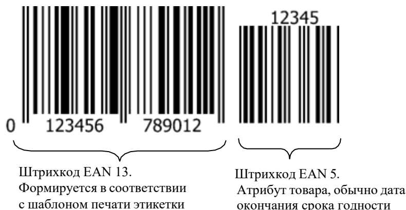
Рис. 6.2 – Структура штрихкода EAN 13+5
